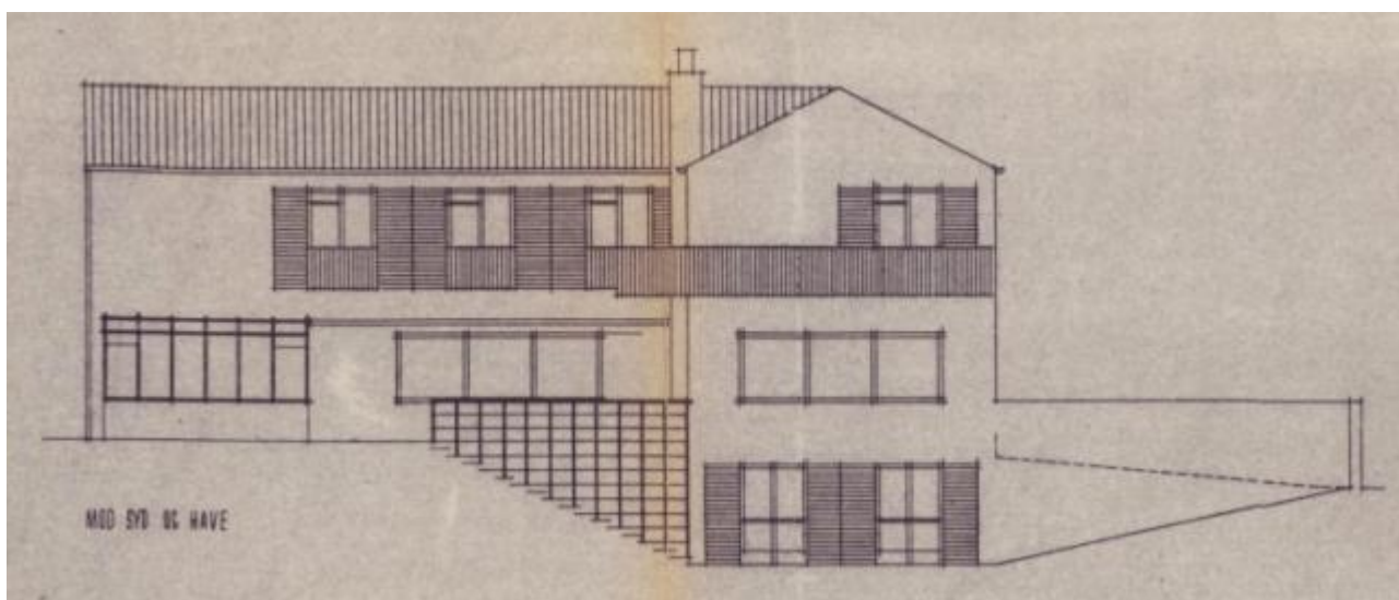
Sydfacaden mod have (og Lundely). Havens niveauforskelle giver 3 etager i den østlige ende og to mod vest.
