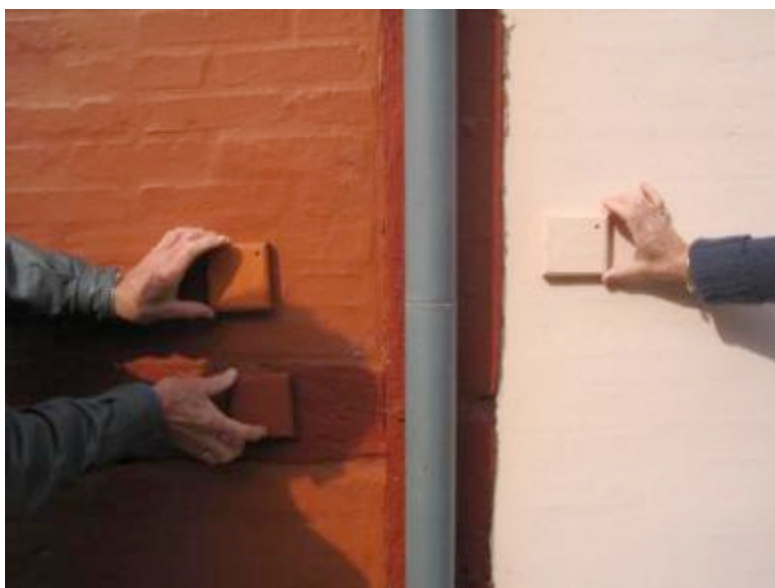
Check af de fremstillede farveprøver – her i kalkfarver i modsætning til facaden.
